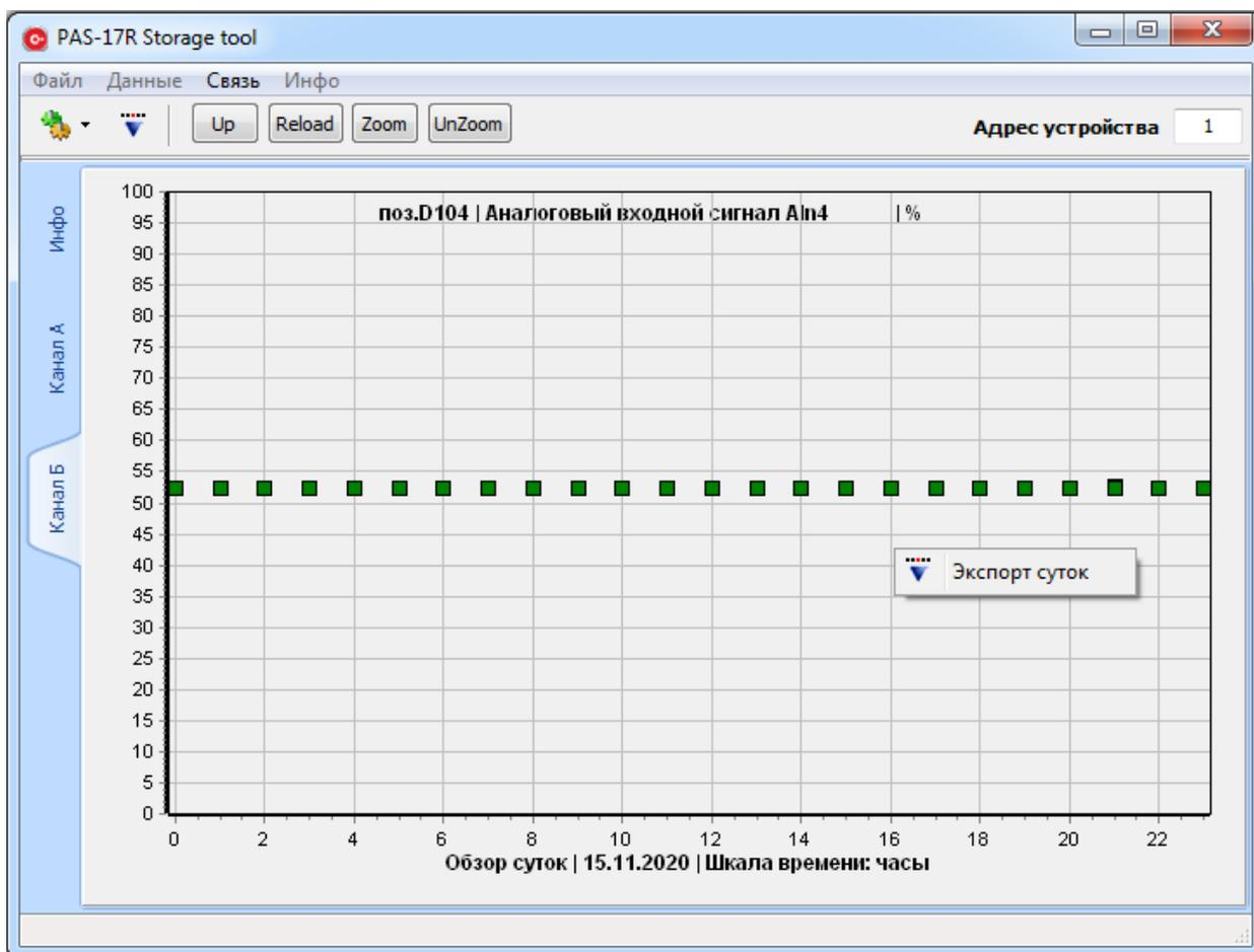
При этом программа загружает 24 часовых блока данных за выбранную дату и на отдельной вкладке формирует график в виде «свечей Min / Max» представляющие накопленные данные за сутки - всего  $24 * 60 = 1440$  элементов.
