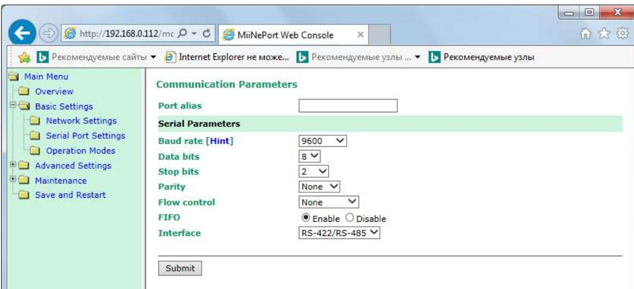
Настройки Serial Parameters должны соответствовать настройкам внутреннего последовательного интерфейса МЦП ПАС-17. Заводские установки последовательного интерфейса: 9600 бод, 2 стоп бита, без контроля четности. Изменения настроек внутреннего последовательного интерфейса МЦП ПАС-17 могут быть внесены с лицевой панели прибора (см. раздел 5.1). При этом нужно иметь в виду,
