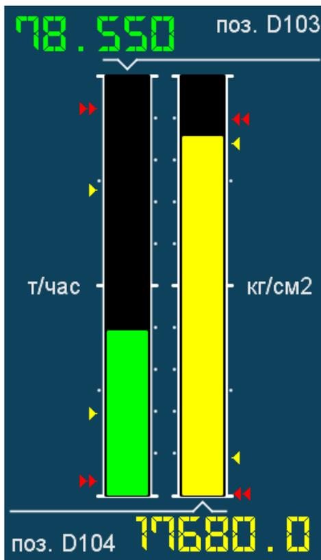
**5.1.1** После запуска прибора на экране отображается стартовый обзорный экран, на котором в текстовой и графической форме (барграфы) представлены параметры обоих каналов измерения с реквизитами. Вверху / слева отображается канал измерения А, внизу / справа - канал Б.
