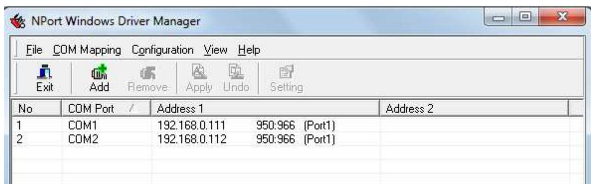
Протокол обмена для прикладной программы, установленной на ПК: ModBus RTU, режим MASTER, настройки обмена для COM порта должны соответствовать настройкам внутреннего последовательного интерфейса МЦП ПАС-17, доступ к переменным SLAVE через стандартные функции ModBus 1, 2, 3, 4, 5, 15, 16.
