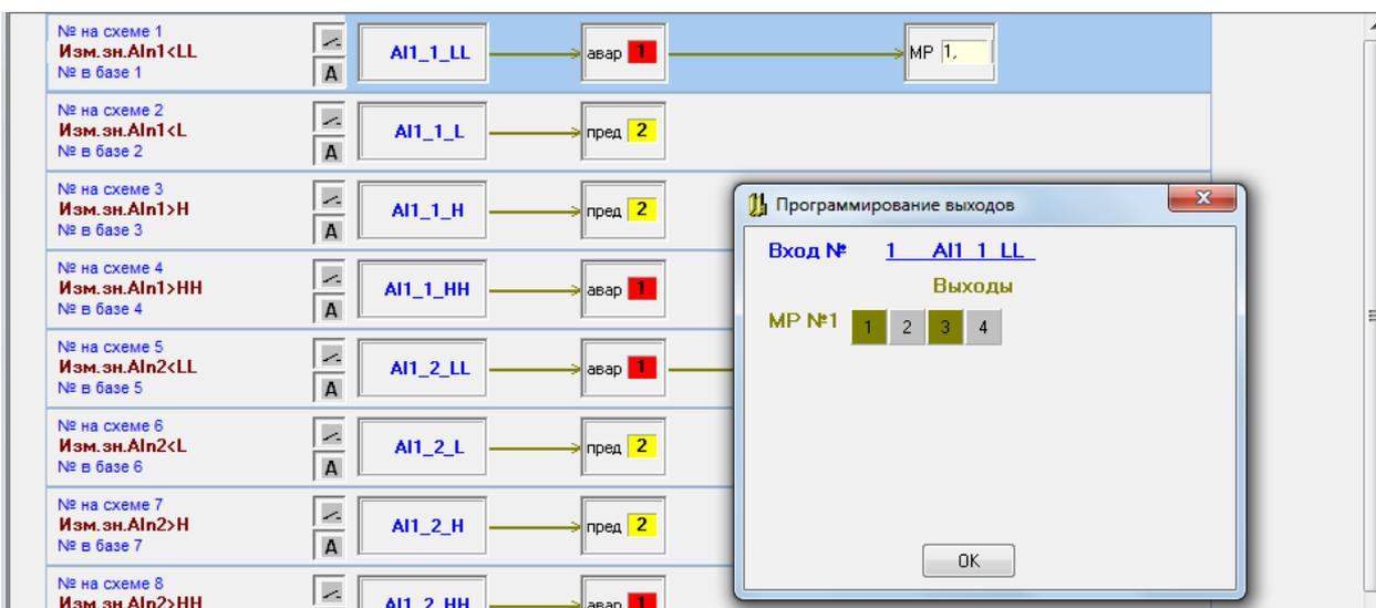
На форме программирования модуля МУВР имеется кнопка «on line дискретных выходов», которая позволяет в режиме on line наблюдать состояние релейных выходов модуля.
