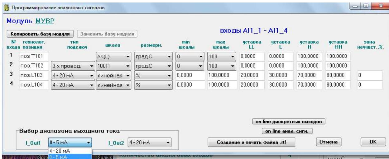
Выходной сигнал пропорционален выбранному входному аналоговому сигналу в режиме повторителя сигнала.
