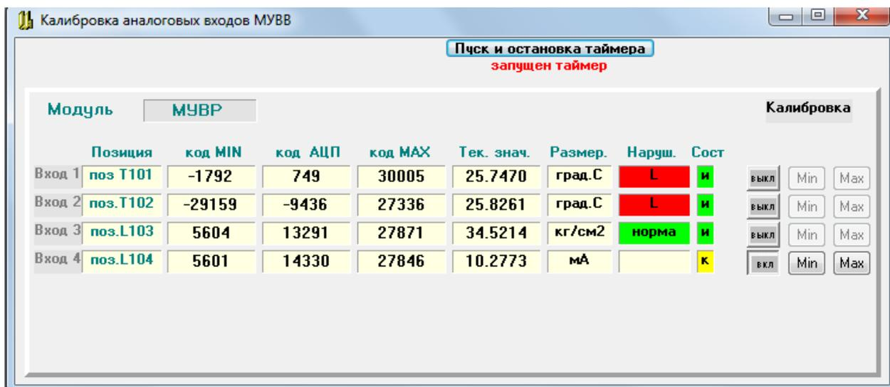
Для калибровки необходимо подключить к калибруемому входу источник входного сигнала и образцовое средство измерения входного сигнала классом точности не ниже 0,05 % или подать входной сигнал от соответствующего калибратора.
