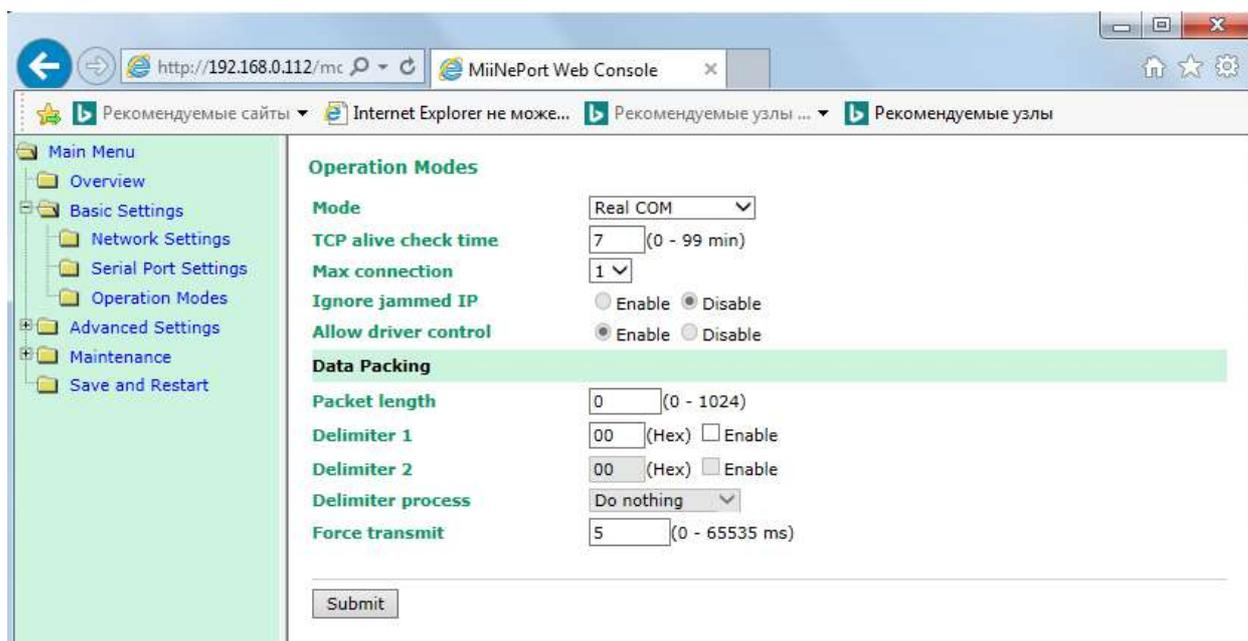
Установить настройки, как указано на рисунке. Принципиально важной является настройка параметра Force transmit. Значение этого параметра =5 ms (в заводских настройках фирмы MOXA этот параметр =0) является длительностью разрыва потока данных, по которому производится переключение внутреннего последовательного интерфейса MiiNePort E3 с режима «ПЕРЕДАЧА» на режим «ПРИЕМ» данных.
