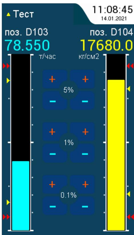
**5.1.11** Экран имитации входных сигналов, предназначенный для тестирования прибора. При переходе на данный экран создается локальная копия входных данных и последующие манипуляции пользователя не оказывают влияния на рабочий цикл / данные прибора и не фиксируются в архиве.
