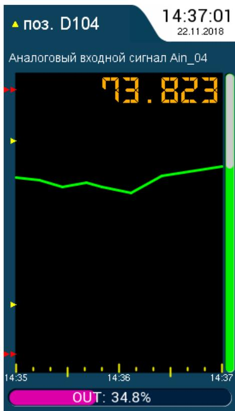
**5.1.3** На экране графического представления выбранного канала отображен график измеряемой величины в реальном масштабе времени совместно с ее текстовыми реквизитами и значением выхода повторителя, при этом каждая точка графика соответствует измеренному значению (1 точка – 1 секунда).
