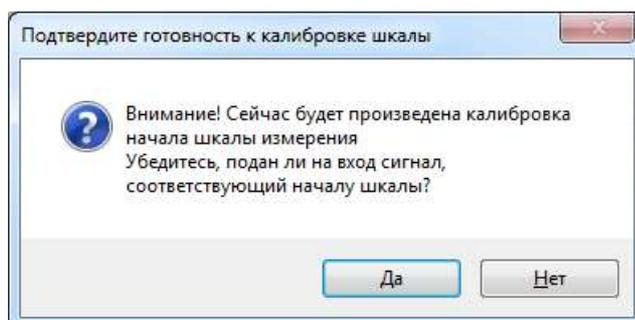
Нажать кнопку «Да», при этом команда калибровки MIN поступает в прибор. В модуле МУВР значение входного сигнала, зафиксированное в данный момент в виде двоичного кода АЦП, запоминается в EEPROM модуля в качестве нижней реперной точки измерительного канала данного входа (код MIN).
