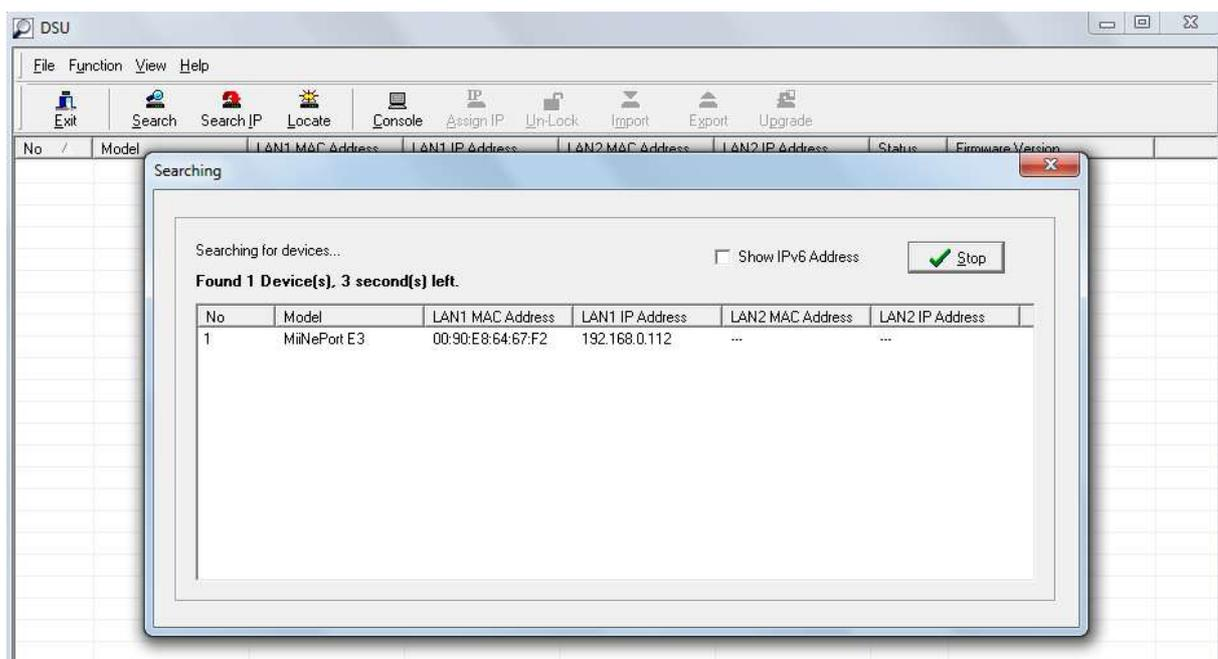
С найденным модулем MiiNePort E3 можно связаться в режиме WEB консоли, для этого нужно выделить требуемый модуль и нажать кнопку Console.
