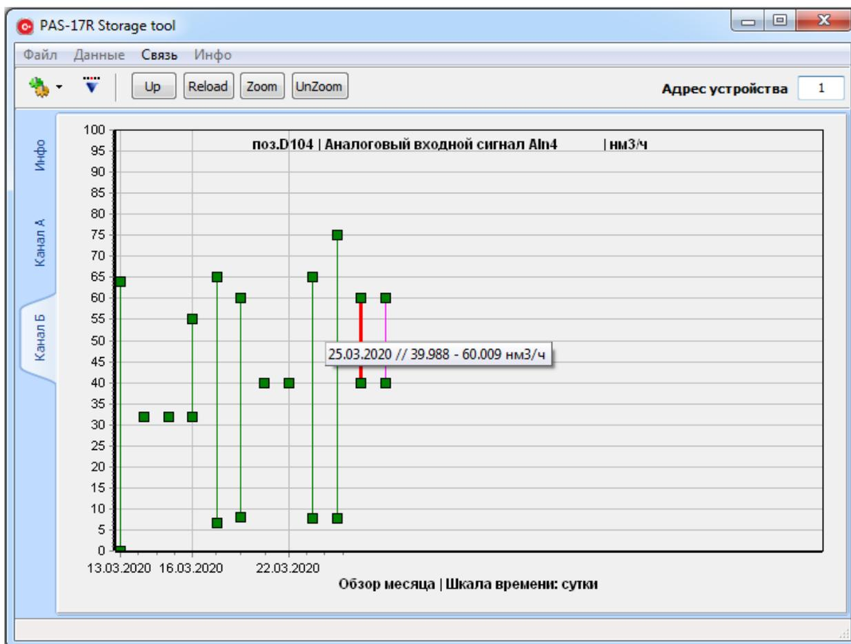
На графике в виде «свечей Min / Max» представлены накопленные данные за месяц. В верхней части расположены текстовые реквизиты канала измерения + технологическая позиция + единица измерения. Снизу указывается отчетный период (месяц) и шкала времени (сутки).
