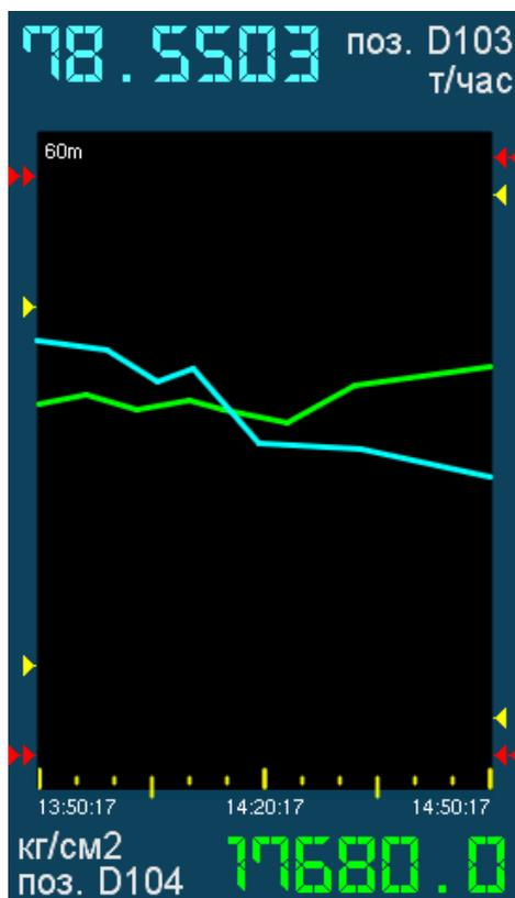
**5.1.2** Альтернативный обзорный экран, на котором в виде графиков с изменяемой скоростью движения представлены результаты измерения обоих каналов с их реквизитами. Вверху отображается канал измерения А, внизу - канал Б. При этом при задании скорости движения в диапазоне 10 - 120 минут на экран каждая точка графика представляет собой вертикальный штрих с началом и концом, соответствующим Min / Max входной величины за заданный период (5 - 60 секунд). Настройка – на экране 5.1.8.
