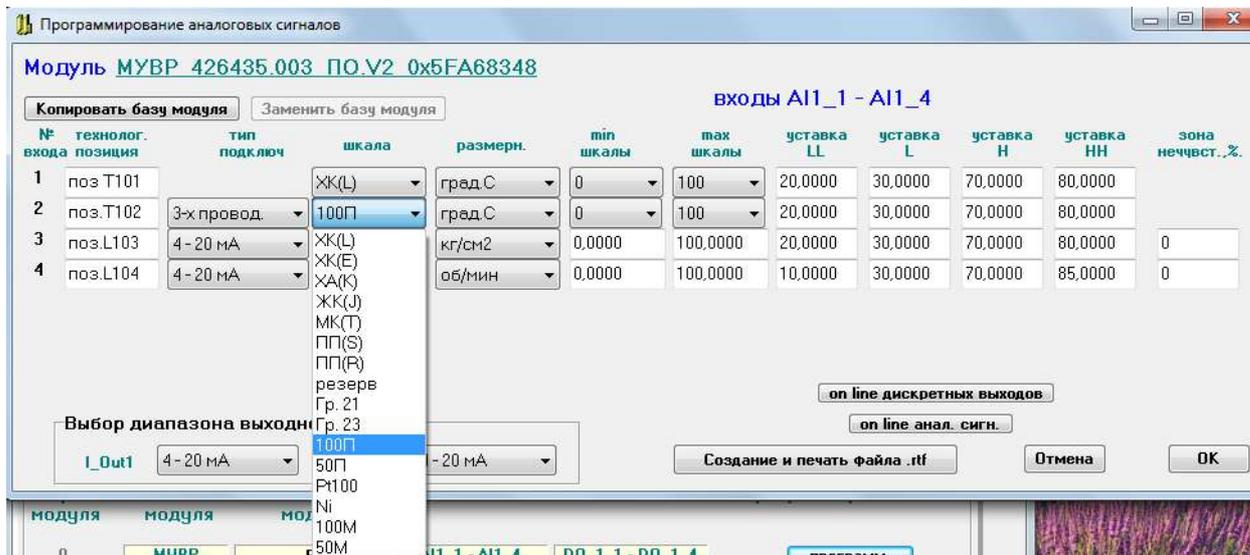
В зависимости от типа первичного термопреобразователя для входов №1 и №2 допустимыми являются следующие фиксированные значения начала и конца шкалы (выбираются из списков «min шкалы» «max шкалы»):
