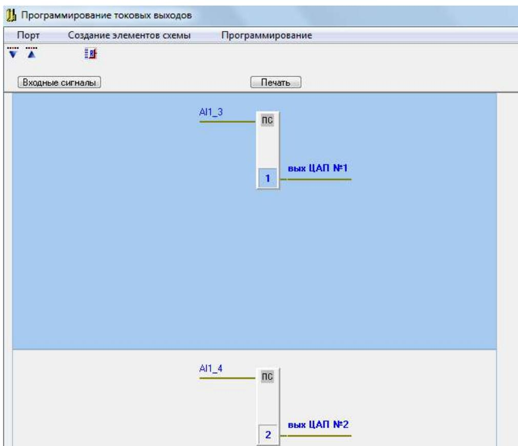
Для задания выбранного аналогового входного сигнала на вход повторителя сигнала, на выбранном повторителе правой кнопкой мыши вызывается форма «Редактирование токового выхода».
