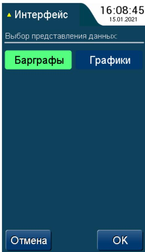
**5.1.9** Экран выбора вариантов основного обзорного экрана регистратора: барграфы 5.1.1 или графики 5.1.2.
