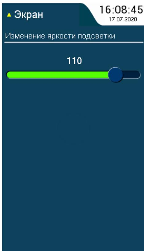
**5.1.7** Экран регулировки уровня подсветки LCD экрана - содержит полосу прокрутки с маркером, перетягивая который можно установить требуемую яркость.
