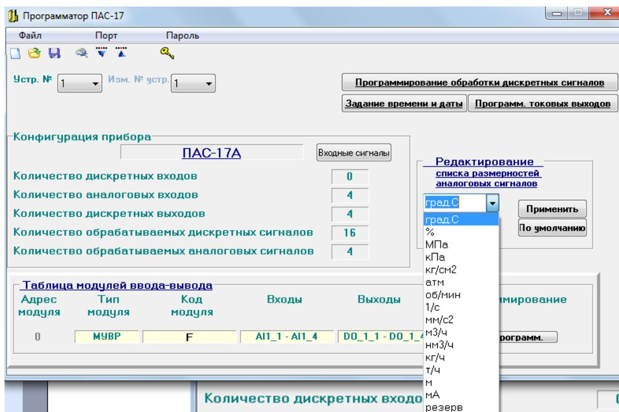
Если к входу №1 подключается термопара (ТП - ХК (L), ХК (E), ХА (K), ЖК (J), МК (T), ПП (S), ПП (R)), то к входу №2 должен быть подключен датчик температуры холодного спая термопары – термосопротивление любого из предусмотренных типов, для которого должен быть запрограммирован Min / Max шкалы  $0 \div 100^{\circ}\text{C}$ .
