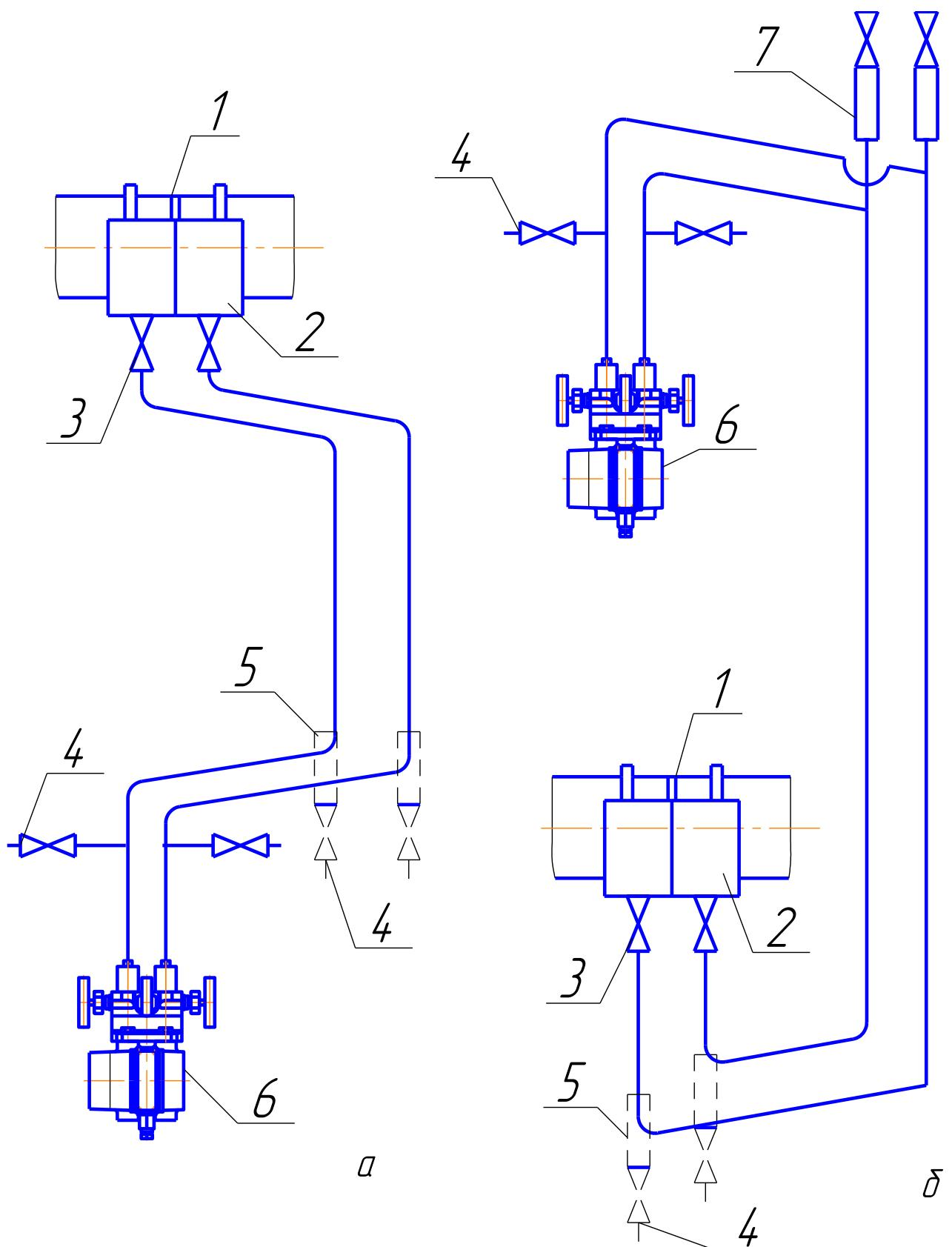
Рисунок 8-Схема соединительных линий при измерении расхода пара
