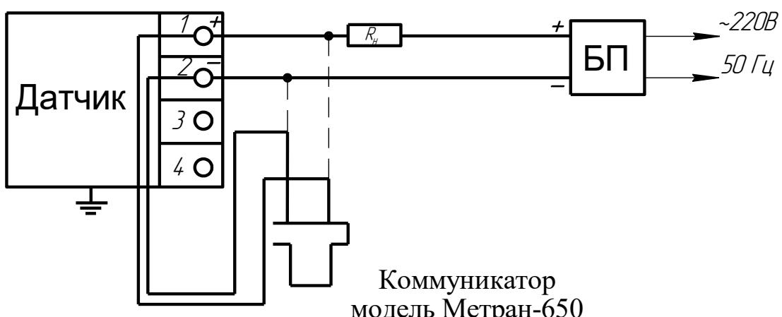
Рисунок Г.2 – Выходной сигнал 4-20 мА
