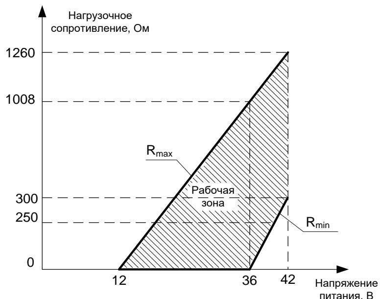
$R_{min}=250$  Ом для датчиков с HART-сигналом
