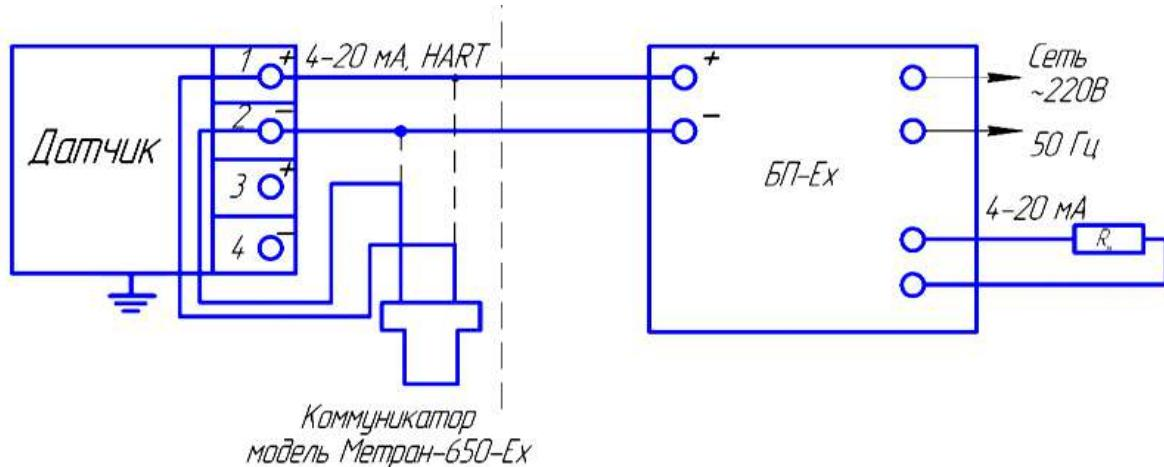
БП-Ex - искробезопасный блок питания (например БПД-40-2к-Ex)
